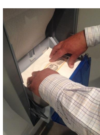
8. Bien appuyer pour que les deux cassettes soient bien connectées l'une avec l'autre.
