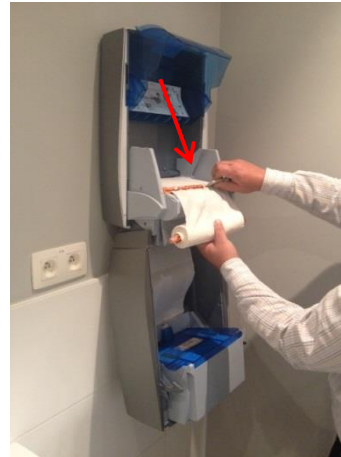
12. Coupez le rouleau dans la rainure orange avec le couteau.
