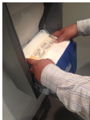
7. Placez la nouvelle cassette sur la bande adhésive de l'ancienne cassette.
