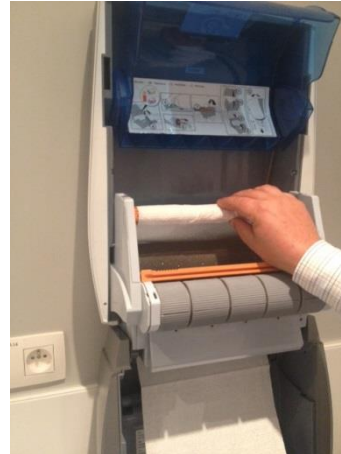
16. Replacer la broche de nouveau dans le support.
