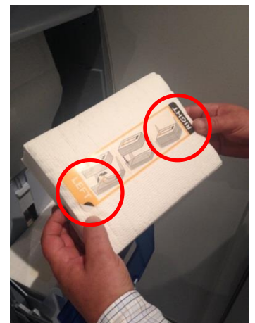
6. Prenez la nouvelle cassette à deux mains, avec la bande couleur vers le haut et dans la bonne direction.
