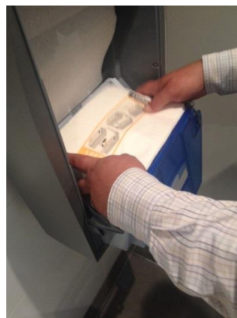
7. Plaats de cassette op de verbindingstrip.
