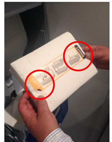
6. Pak de cassette met beide handen vast met het afdekvel boven
